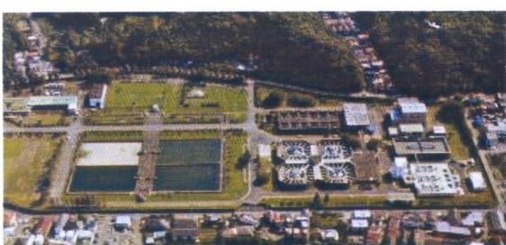
⇒多摩区の生田浄水場で、工業用水に加工 ⇒ 2号送水管で平間配水所へ送水
